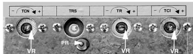
**TCN - Termostato de autorización de nafta:** Calibrar este termostato en un valor inferior 10% respecto al indicado en el diagrama de viscosidad - temperatura).
