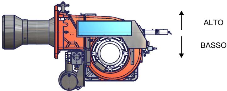
Il bruciatore nasce per funzionare con asse fiamma orizzontale. La parte superiore della flangia di attacco al generatore, deve essere orizzontale al fine di ottenere la corretta inclinazione del barilotto di preriscaldamento. Per installazioni diverse, contattare l'Ufficio tecnico.
