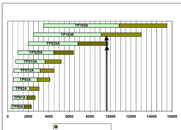
Analice el diagrama resumen de la Fig. 1 para identificar qué quemador o quemadores se encuentran dentro de este rango de potencia (9600 kW). Una vez identificados los tipos de quemadores, hay que elegir el más adecuado en función de razones técnicas y económicas.
