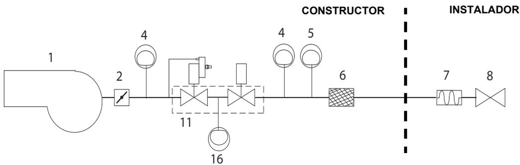
\*Nota: el presostato de máxima puede ser montado o después de las válvulas del gas o antes el grupo y después de la válvula de mariposa (ves esquema - elemento 4).
