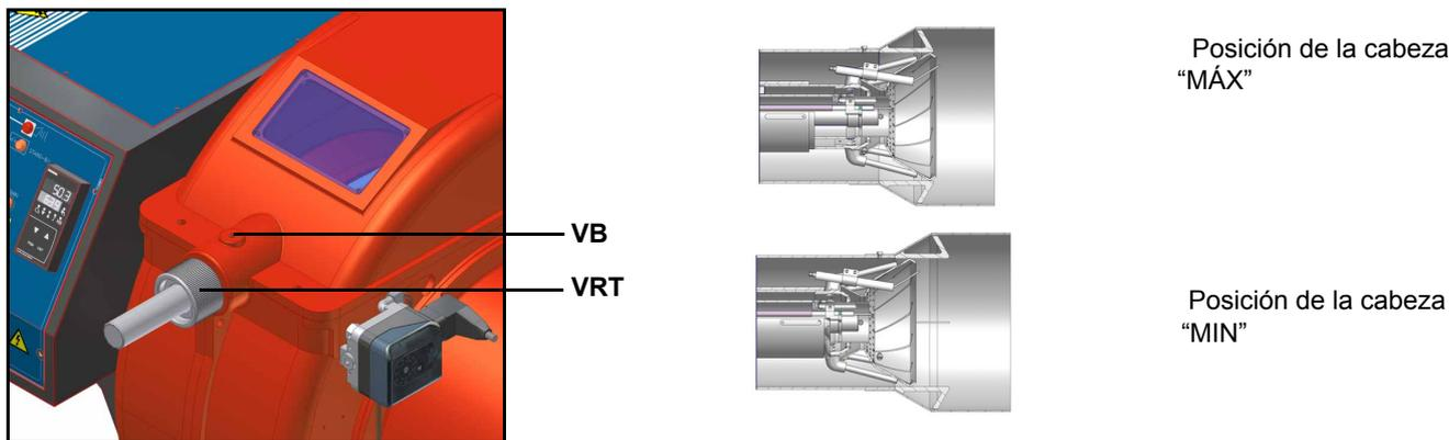
**Atención:** Regular la cabeza de combustión solo si necesario. Si se modifica la posición de la cabeza, repetir las regulaciones de aire y gas descritas en los puntos anteriores.
