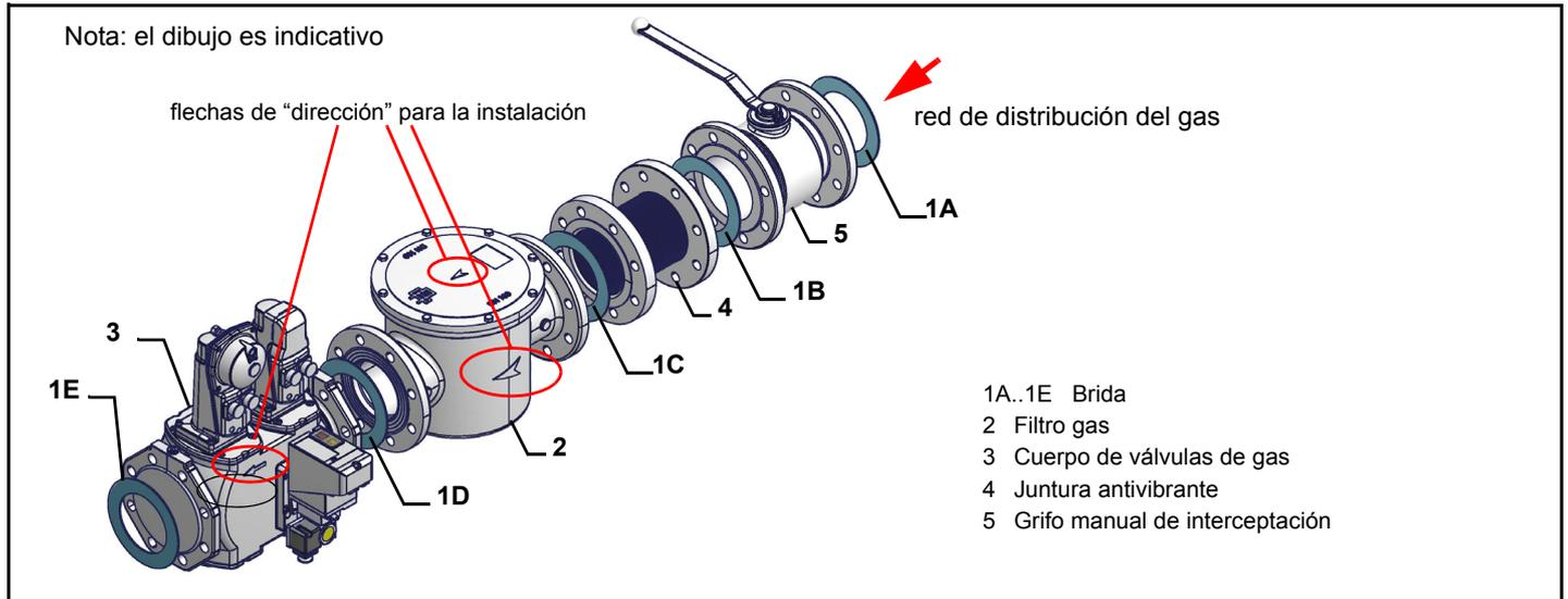
Montaje del cuerpo de válvula en la línea de gas:
