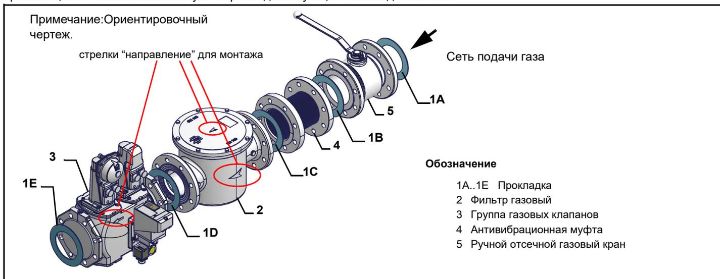
Монтаж корпуса клапана на газовой линии:
