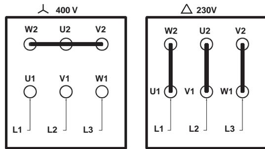
**Присоединение нагревательных элементов (для подогрева мазута)**
