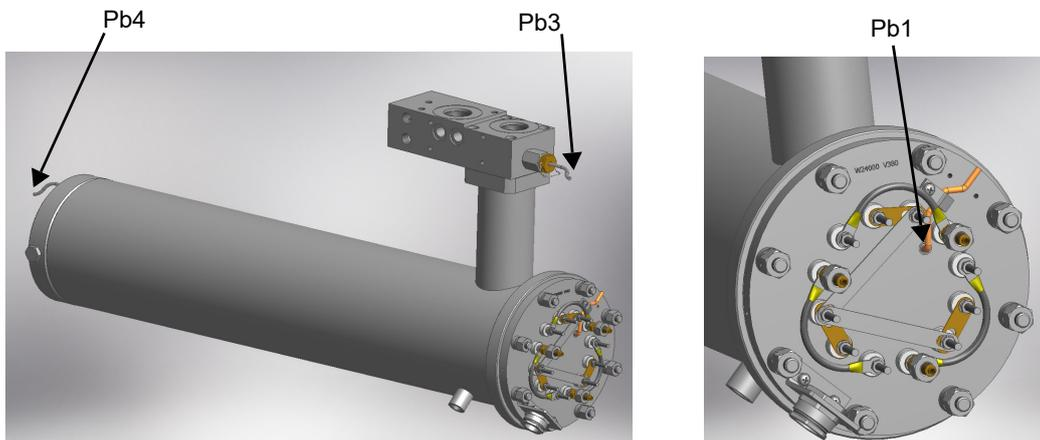
Рис. 19 Подключение датчиков Danfosst MCX
