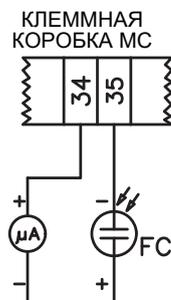
Рис. 20 - Контроль пламени с помощью фотоэлемента QRA.
