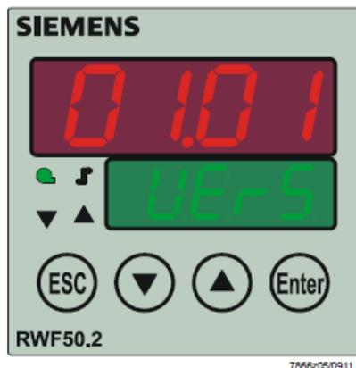
Для того, чтобы визуализировать версию программного обеспечения (software) прибора, нажать на **Enter + стрелка вверх**.
