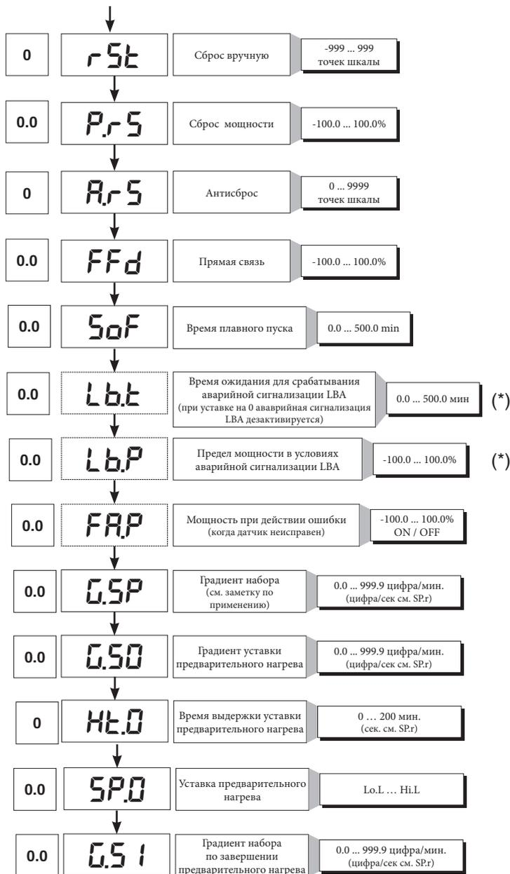
(\*) Если аварийная сигнализация LBA активирована, можно аннулировать ее нажатием на клавиши Δ + ∇, когда на дисплее отображено величина значения выхода регулирования (OutP), или перейдя в ручной режим.
