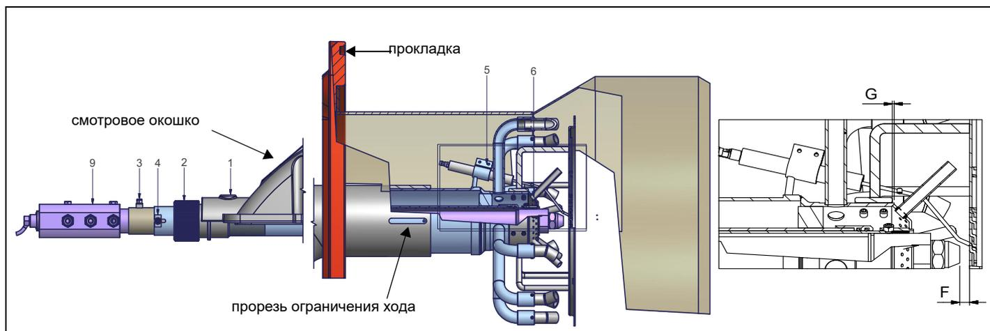
**Регулировка форсунки относительно головы сгорания "8" (отметка F):**
