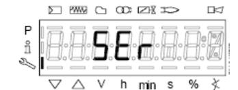
Il livello Service permetti di visualizzare informazioni sull’intensità di fiamma, posizione servocomandi, numero e codici di blocco:
