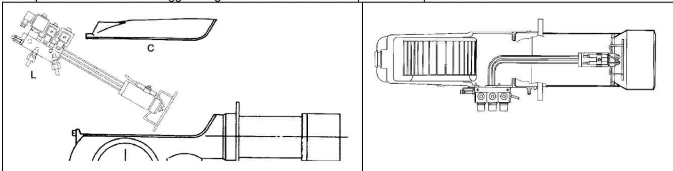
**Corretta posizione degli elettrodi e della testa di combustione**
