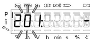
Nell'esempio inseriremo la configurazione: **1** = accensione diretta a gas (G mod).
