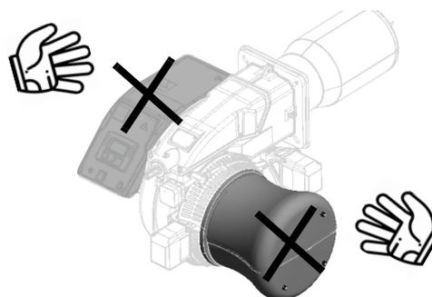
Il bruciatore è provvisto di golfari per il sollevamento e può essere spostato con sollevatore idraulico o piccola gru manuale (A)
