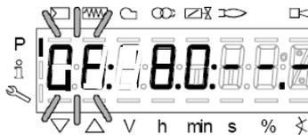
Volendo impostare l'angolo di apertura della serranda dell'aria "0A" nel punto di accensione (per esempio a 10° - vedi sotto) premere "A" e contemporaneamente "+" oppure "-":
