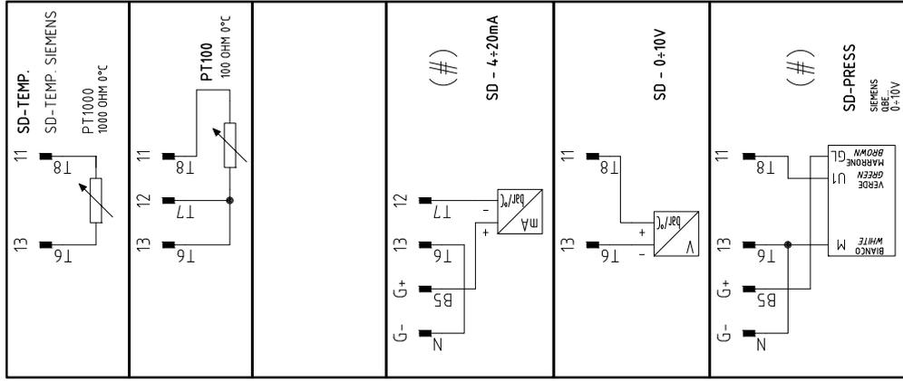
(#) Collegamento solo per trasduttori passivi
