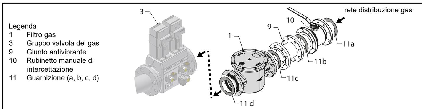
Montaggio corpo valvola sulla linea gas dedicata: per montare i gruppi valvole gas, sono necessarie 2 flange filettate o flangiate a seconda del diametro
