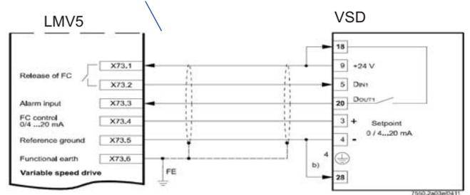
**Note:** Se l'LMV5 è montato in un armadio, in alternativa a (X73.6 / FE), è anche possibile connettere il cavo PE in armadio
