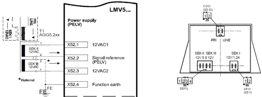
In alcuni casi, connettere il terminale X52.2 con FE, migliora la resistenza dell'LMV5 ai disturbi EMC. Effettuare la connessione e controllare: nel caso non ci fosse alcun miglioramento, rimuovere la connessione.
