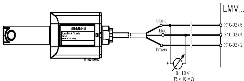
Fig. 20 - Rilevazione con fotocellula QRI..
