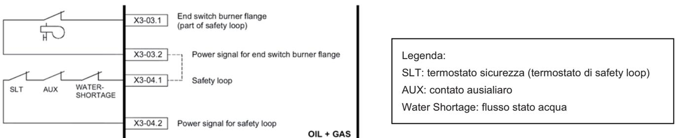
Nel caso di bruciatori progettati per l'estrazione automatica dalla caldaia, ai morsetti X3-03.1 e X3-03.2 è collegato il microinterruttore di finecorsa della flangia bruciatore. In caso di apertura del contatto, il bruciatore si spegne immediatamente.
