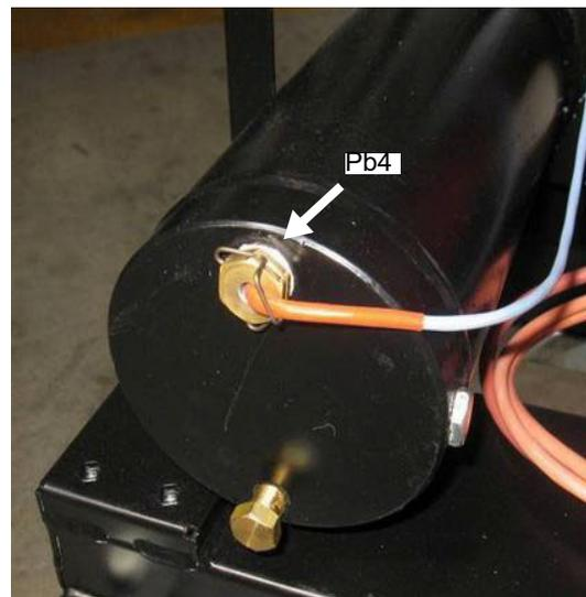
Fig. 11 - Collegamenti sonde Danfoss MCX
