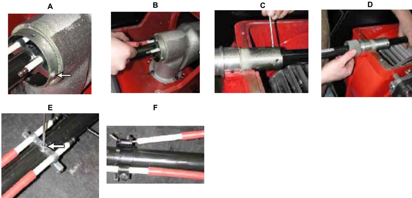
**Sostituzione dell'elettrodo di rilevazione (per bruciatori di gas naturale)**
