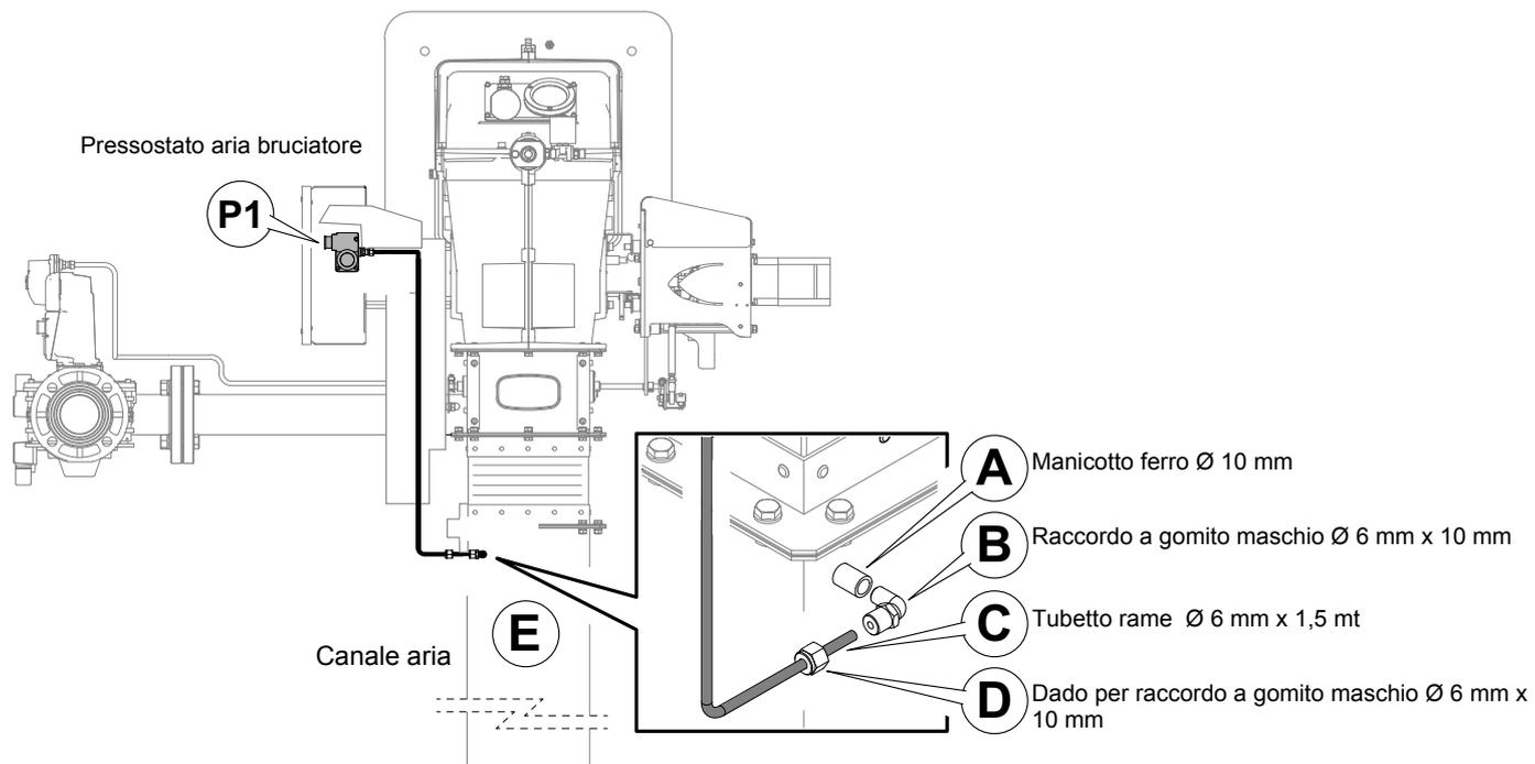
Collegamento tubetto di rame Ø 6 mm:
