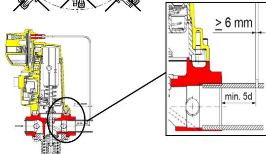
Siemens VGD... con SKPx Esempio di rampa gas
