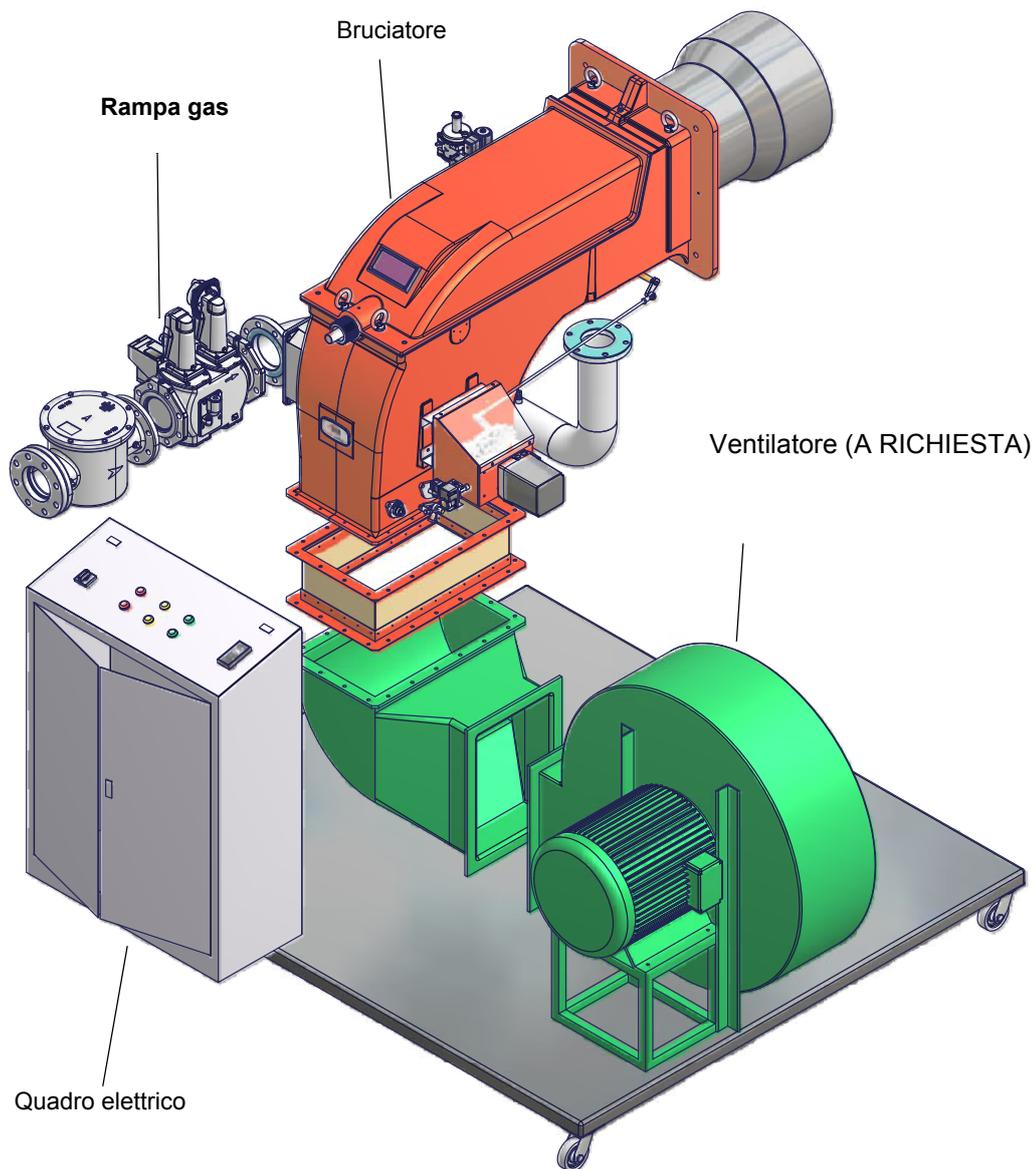
Nota: la figura è puramente indicativa. Il ventilatore e il quadro elettrico possono essere posizionati a discrezione del cliente.
