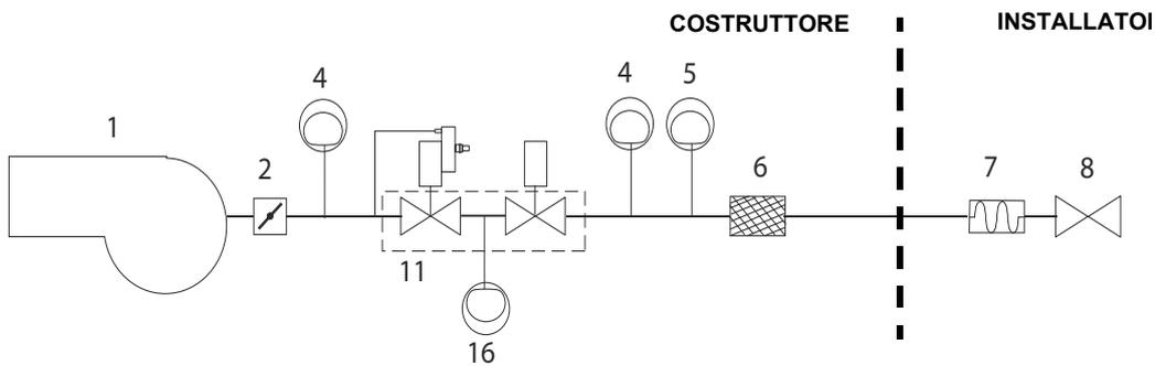
**\*Nota:** il pressostato di massima può essere montato o a monte o a valle delle valvole del gas, ma a monte della valvola a farfalla (vedi schema - elemento 4).
