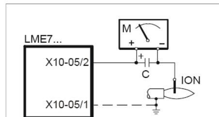
Fig. 11: Rilevazione con elettrodo
